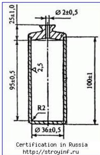
Рисунок 3- Пикнометр
