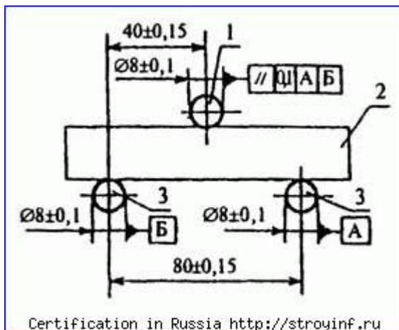
1- нагрузочный элемент, 2-образец-балочка; 3-опора
